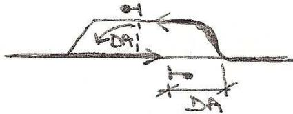
6) intrare și ieșire de același sens la linii dif., intrarea cu oprire în stație, la semnal cu drum de alunecare
