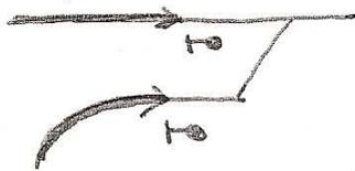
5) intrări din sensuri dif. la linii dif., cu oprire în stație la semn. cu drumuri de alunec.
